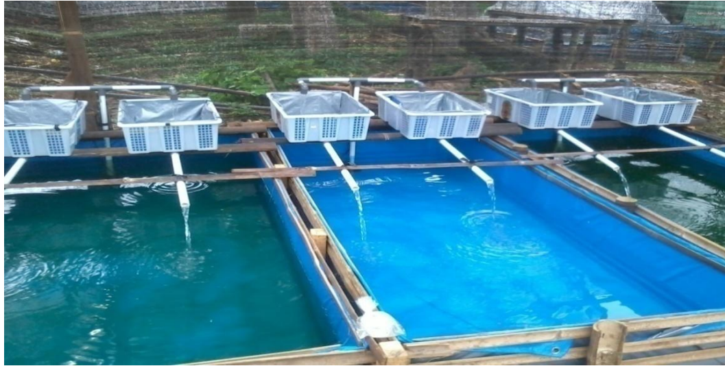
Gambar 2. Sistem Resirkulasi Kolam Terpal
