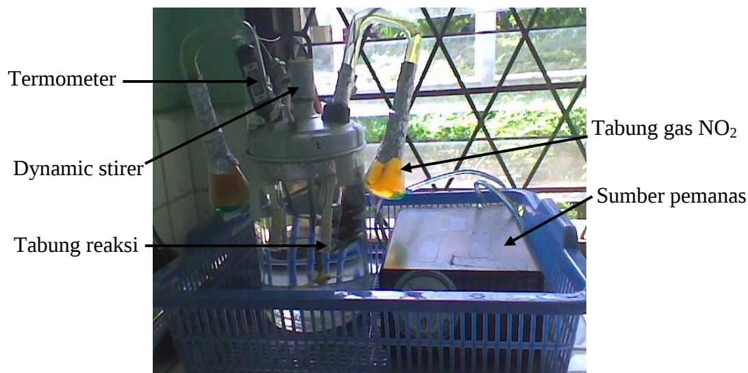
Gambar 7. Rangkaian termostat untuk mereaksikan senyawa kompleks Cis -[Co(phen) 2 (CN) 2 ] dengan gas NO 2 pada suhu bervariasi dan pH 7
