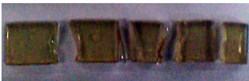
Gambar 28. Patahan spesimen uji bending resin poliester
