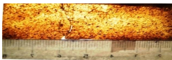
Gambar 20. Patahan Tarik komposit 10% Partikel TK
