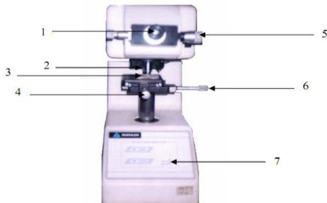
Gambar 20. Alat pengujian kekerasan vickers
