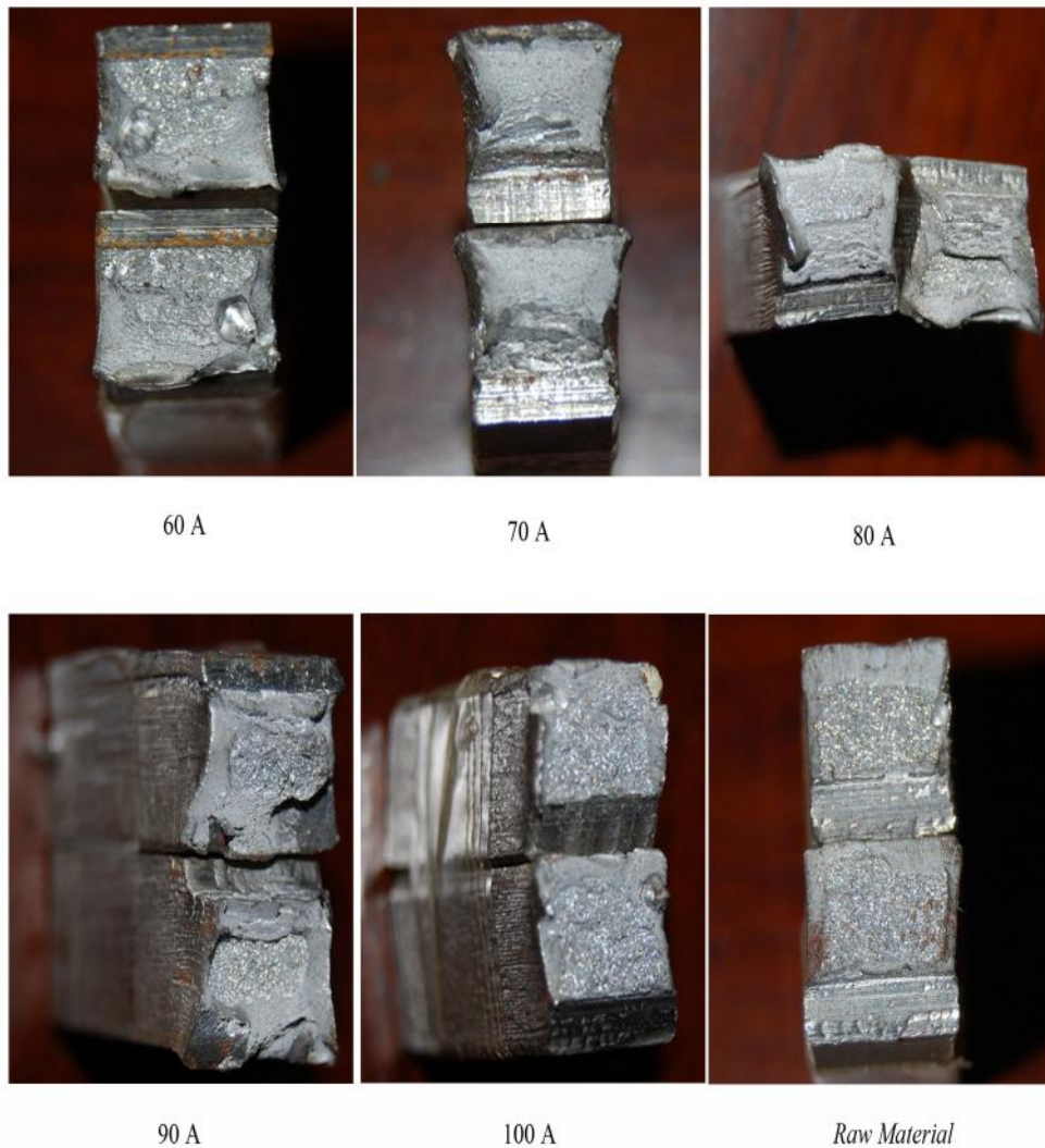
Gambar 23. Patahan spesimen hasil pengujian impact
