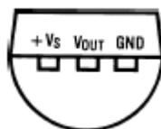
Gambar 21. Susunan pin sensor LM35
