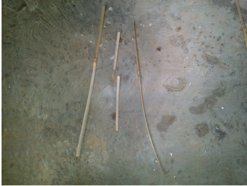
Gambar 15. Sampel bambu yang terirat tidak baik
