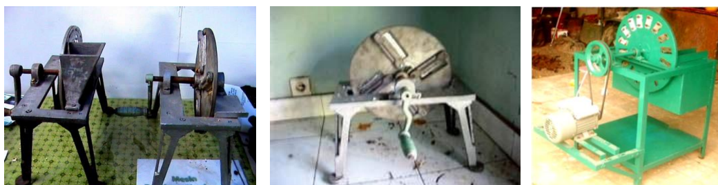
Gambar 2. Perajang singkong tipe vertikal
