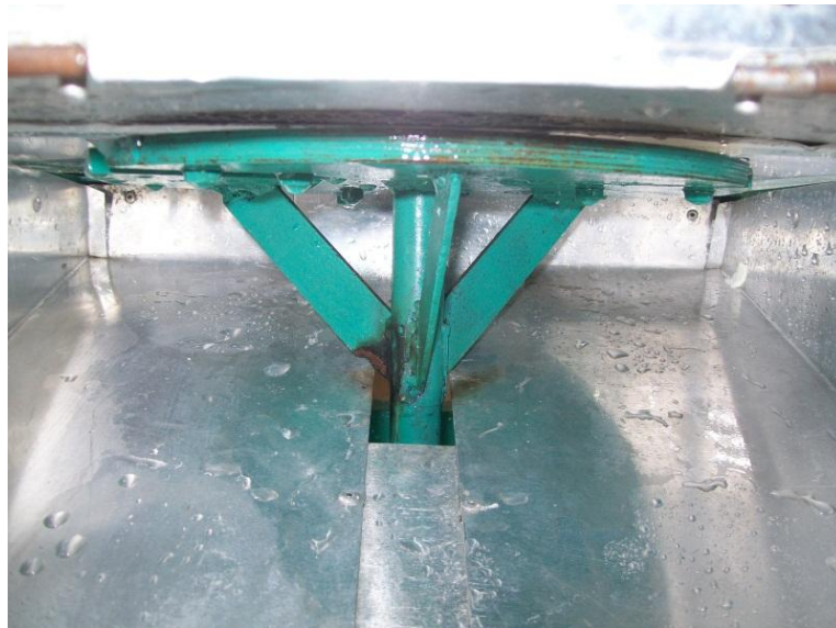
Gambar 9. Besi As sebelum modifikasi (Labonardo, 2010)
