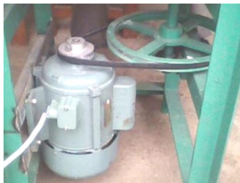
Gambar 13. Sistem transmisi (Labonardo, 2010).
