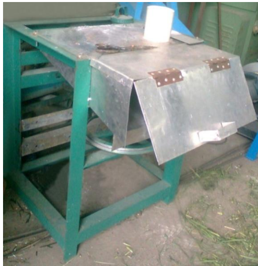
Gambar 4. Alat perajang singkong tipe horizontal (Labonardo, 2010).
