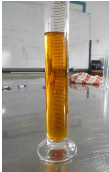
Gambar 3. Biodiesel yang telah dipisahkan dari air
