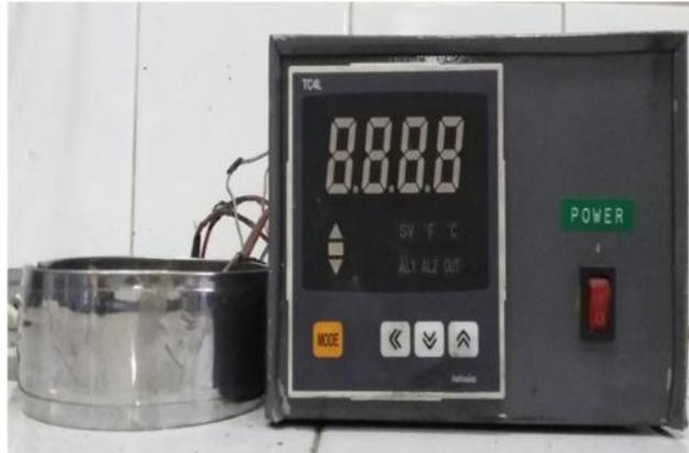
Gambar 30. *Thermo controller* dan *heater*
