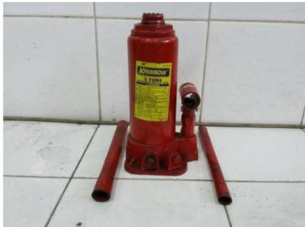
Gambar 16. Dongkrak hidrolik
