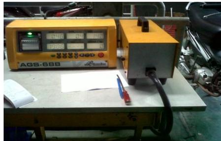
Gambar 18. Kalibrasi *gas analyzer*
