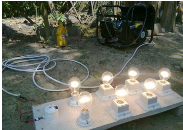
Gambar pengujian konsumsi bahan bakar dengan beban 700 Watt.
