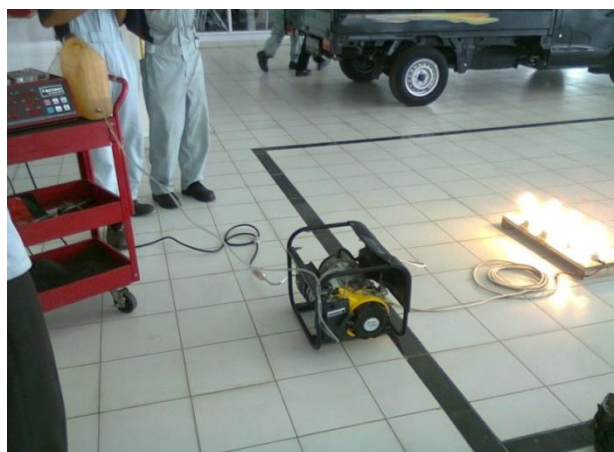
Gambar pengujian emisi gas buang dengan beban 700 Watt.
