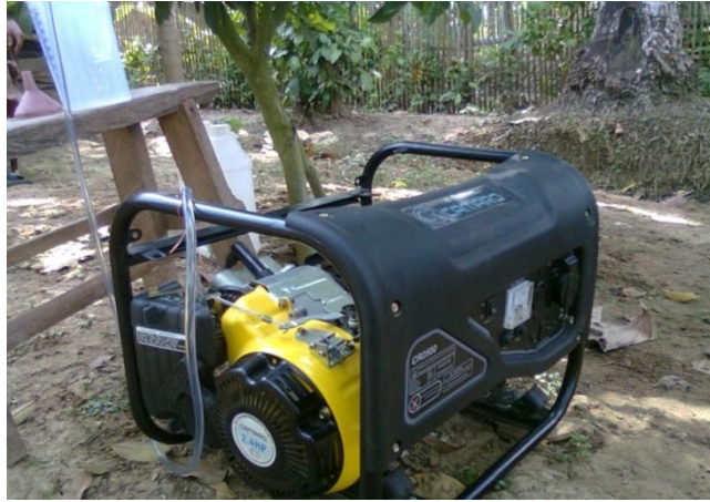
Gambar pengujian konsumsi bahan bakar tanpa beban.
