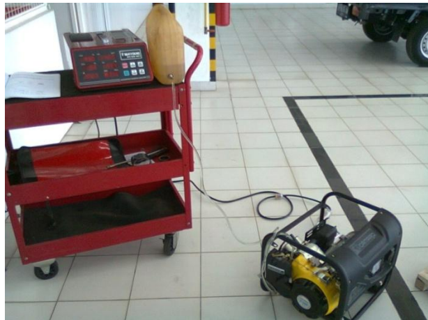
Gambar pengujian emisi gas buang tanpa beban.
