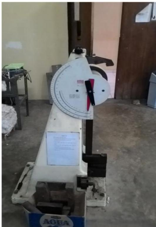
Gambar 6. Mesin uji impak
