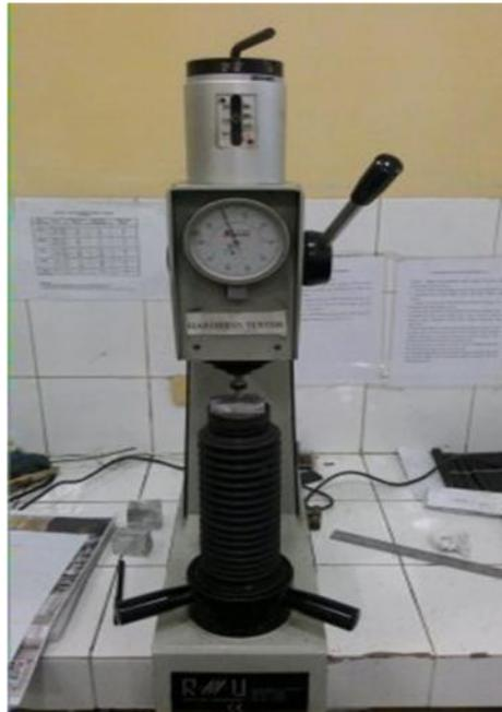
Gambar 4. Alat uji kekerasan material logam
