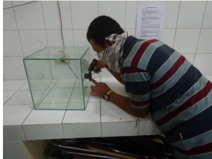
Gambar 3.16. Pembuatan inkubator untuk proses curing dengan kaca tebal 5 mm.
