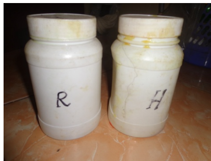
Gambar 3.17. Resin dan hardener dengan perbandingan 1 : 1.
