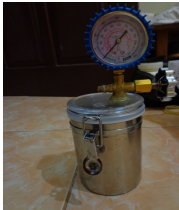
Gambar 3.20. Tabung vakum dengan pressure gauge .
