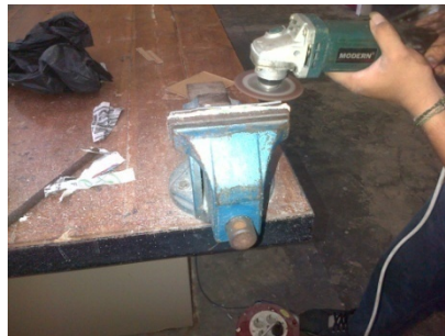
Gambar 3.28. Penggerindaan spesimen yang telah dipotong.
