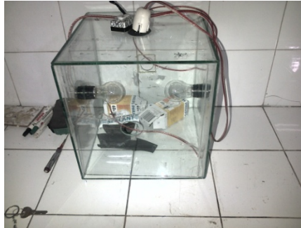
Gambar 3.3. Inkubator untuk proses curing komposit.
