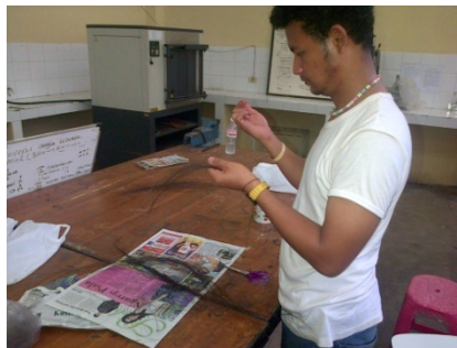
Gambar 3.9. Pemilihan serat ijuk dengan micrometer sekrup.
