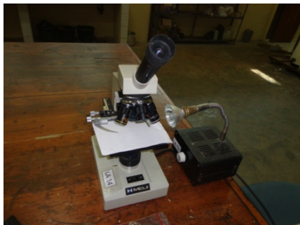
Gambar 3.5. Mikroskop optik untuk mengamati struktur mikro patahan
