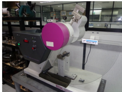
Gambar 3.4. Alat pengujian impak di STP LIPI.
