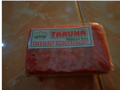
Gambar 3.8. Lilin malam sebagai pencegah udara masuk kedalam sistem vakum.
