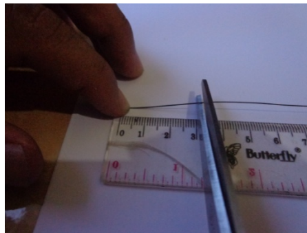
Gambar 3.12. Pemotongan serat ijuk 3 cm.
