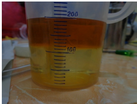
Gambar 3.22. Campuran resin dengan hardener pada gelas ukur.
