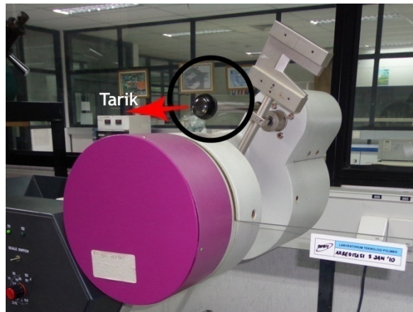
Gambar 3.33. Pelepasan tuas pada pengujian impact.
