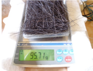
Gambar 3.23. Serat ijuk yang ditimbang untuk prosentasi massa.
