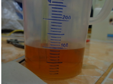
Gambar 3.21. Hardener sebanyak 100 ml pada gelas ukur
