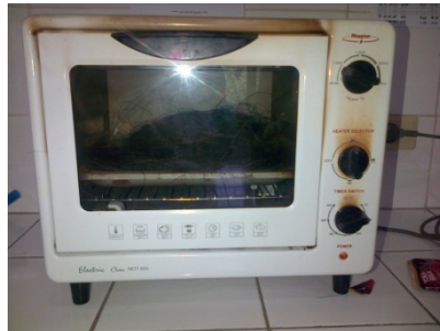
Gambar 3.7. Tungku pemanas untuk menghilangkan kadar air serat ijuk.
