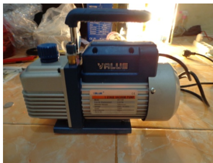
Gambar 3.2. Pompa vakum untuk pembuatan komposit
