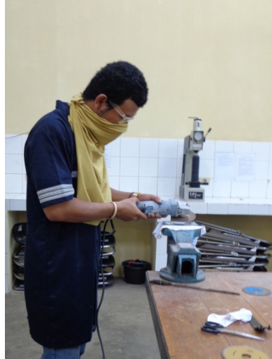
Gambar 3.30. Pembuatan takikan dengan mesin gerinda.
