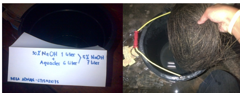
Gambar 3.10. Perendaman serat ijuk menggunakan alkali 5%
