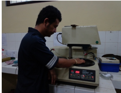
Gambar 3.29. Polish spesimen dengan mesin polisher .
