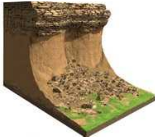
Gambar 4. Longsoran dengan tipe jatuhan atau falls (Diadaptasi dari http://visual.merriam-webster.com/index.php )
