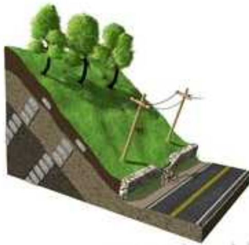
Gambar 3. Tipe longsoran rayapan atau creeps (Diadaptasi dari http://visual.merriam-webster.com/index.php )
