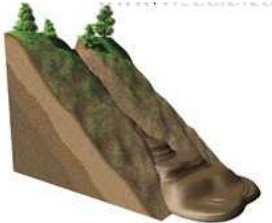
Gambar 2. Tanah longsor dengan tipe aliran atau flows (Diadaptasi dari http://visual.merriam-webster.com/index.php )
