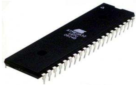
Gambar 2.9. Bentuk Fisik Mikrokontroler ATmega32 (Nana, 2014)
