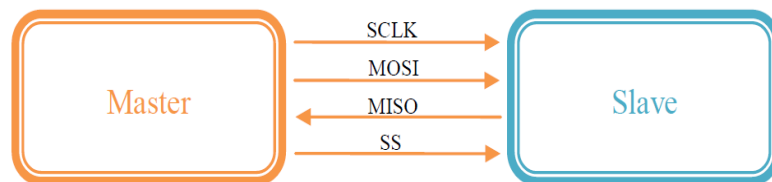
Gambar 2.13. Skema antarmuka komunikasi SPI (Withamana, 2009).
