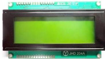
Gambar 2.7. LCD (*Liquid Crystal Display*) dengan karakter 4x20
