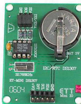
Gambar 2.11. Bentuk umum RTC (*Real Time Clock*)
