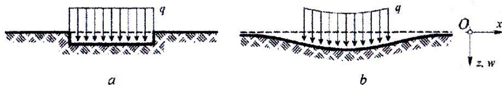
Gambar 7. Defleksi Pondasi Elastis Di Bawah Tekanan Yang Seragam; a = Winkler, b = Pondasi Tanah Praktis
