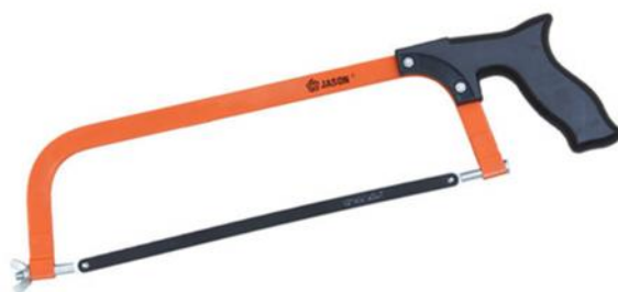
Gambar 9. Gergaji besi digunakan untuk memotong spesimen
