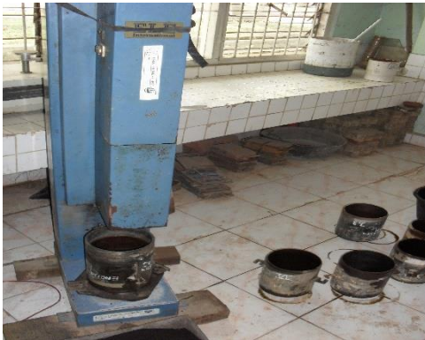
Uji pemadatan tanah
