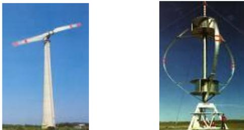
**Gambar 2.15.** Turbin angin Propeller dan Darrieus (Alamsyah, 2007).
