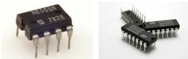
**Gambar 2.13 .** IC NE 555 8 pin DIP dan 14 pin DIP (www.st.com).
