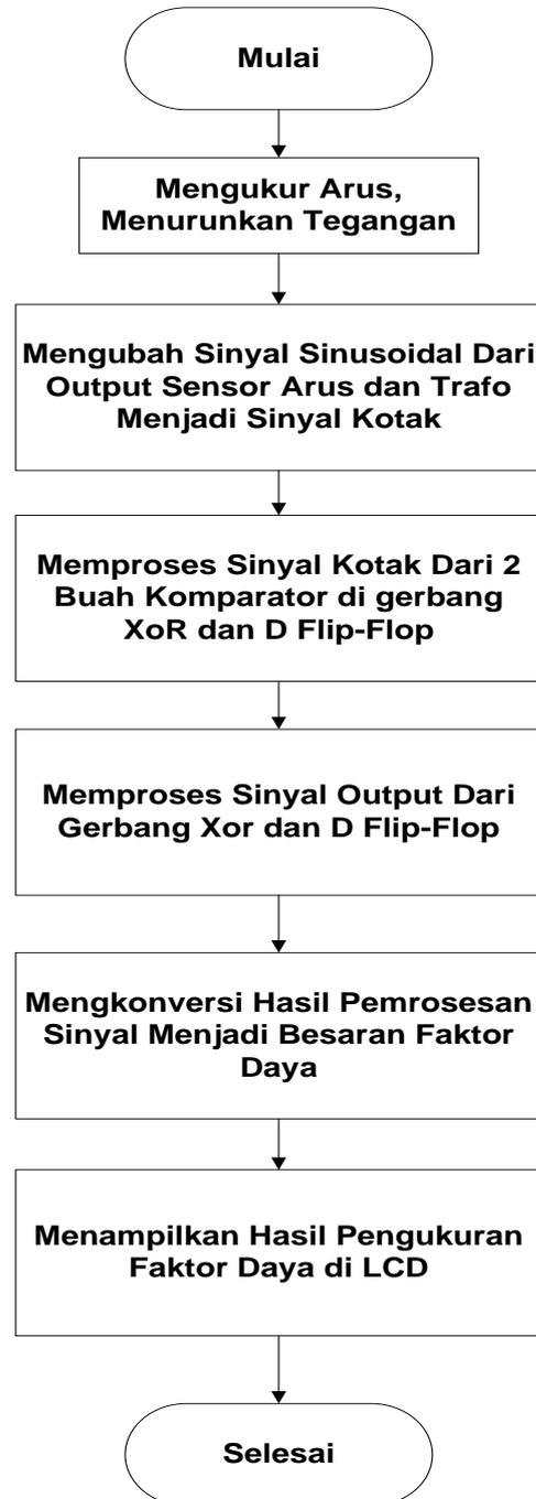
Gambar 3.3 Diagram alir prinsip kerja alat
