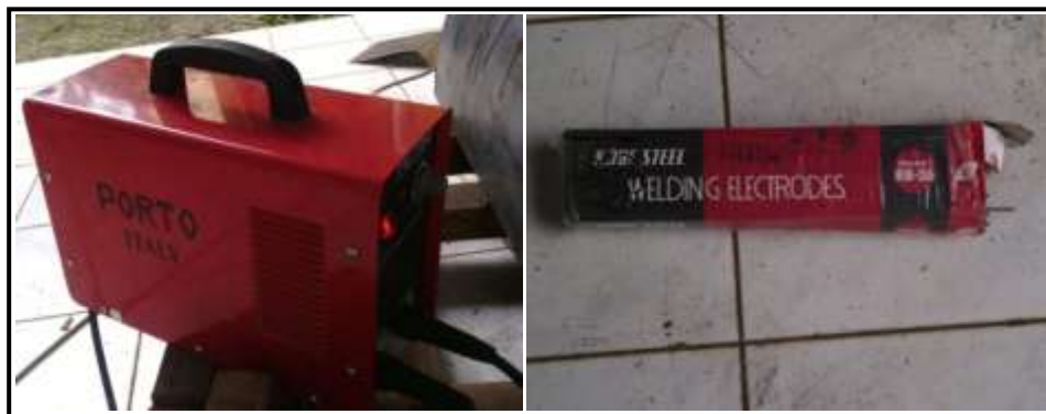
Gambar 12 Mesin las listrik dan elektroda
