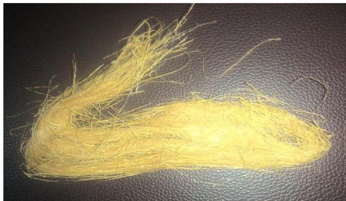
**Gambar 2.11** Serat waru yang telah dilakukan perlakuan NaOH selama 3 jam.
