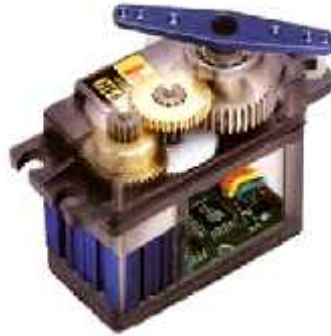
Gambar 2.7 Motor servo dan bagian-bagiannya.
