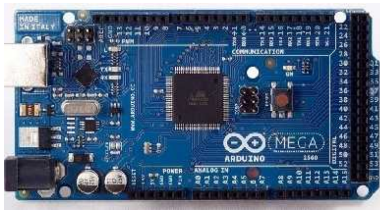
Gambar 2.1 Fisik Arduino Mega2560
