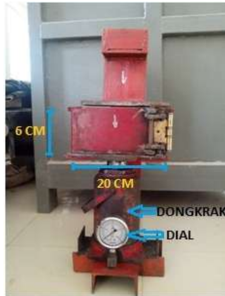
Gambar 5. Alat Pemadat Modifikasi
