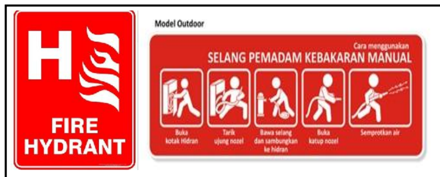
Gambar 12. Rambu tanda penempatan hidran dan cara penggunaannya (Sumber: www.Rambukeselamatankerja.com. Diunduh 8 November 2015)
