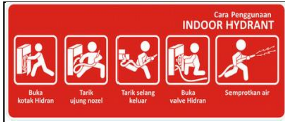
Gambar 11. Rambu cara penggunaan Hidran tembok (gedung) (Sumber: fire-alm.indonetwork.co.id. diunduh 8 November 2015)
