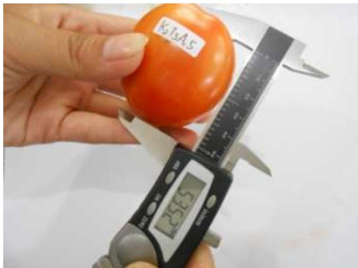
Gambar 13. Pengukuran diameter tomat arah sumbu Y
