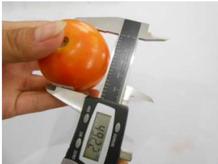
Gambar 12. Pengukuran diameter tomat arah sumbu Z
