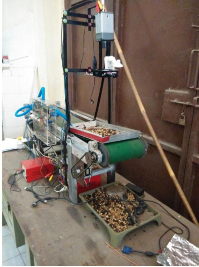
**Gambar 33.** Rangkaian *Conveyor* dan *Thermocam*
