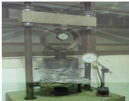
Gambar 4. Pengujian CBR Laboratorium
