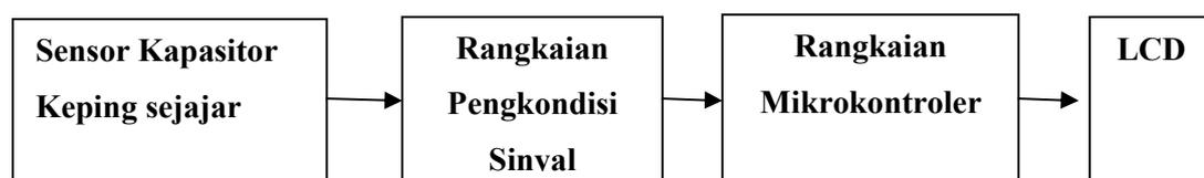
Gambar 3.2. Blok sistem pengukuran konsentrasi kadar gula.
