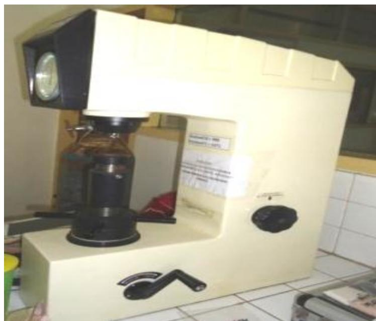
Gambar 5. Uji kekerasan dengan metode *rockwell*.
