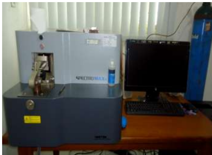
Gambar 7. Alat optical emission spectrometer (OES) (Sumber: Lab. Analisis Kimia dan Metalurgi Balai Penelitian Teknologi Mineral (BPTM)-LIPI, 2016).
