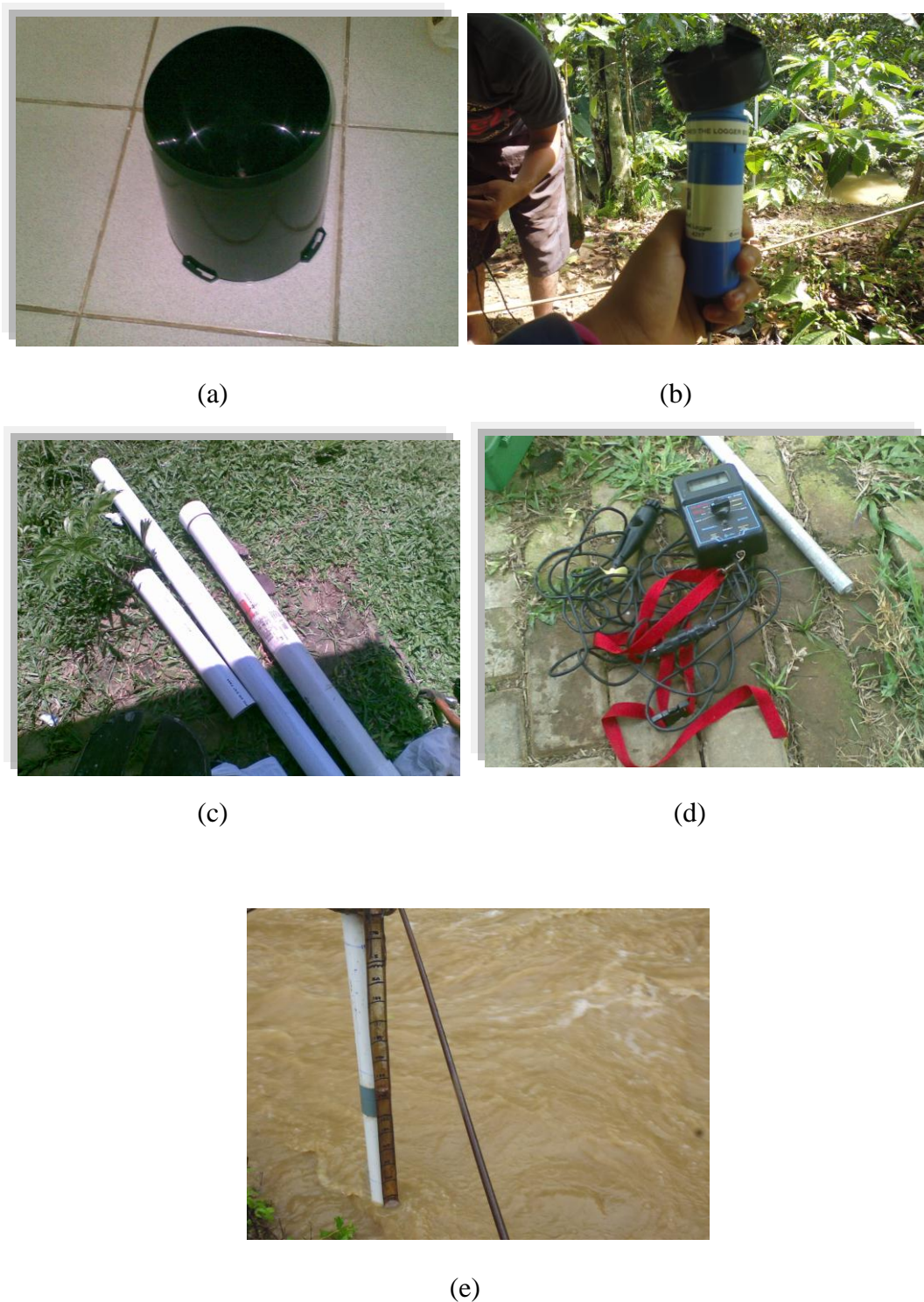
Gambar 8. (a). Alat Penakar Hujan otomatis tipe tipping bucket , (b). Alat pengukur tinggi muka air otomatis atau AWLR, (c). Pipa PVC, (d). Current meter , (e). Peilscale .
