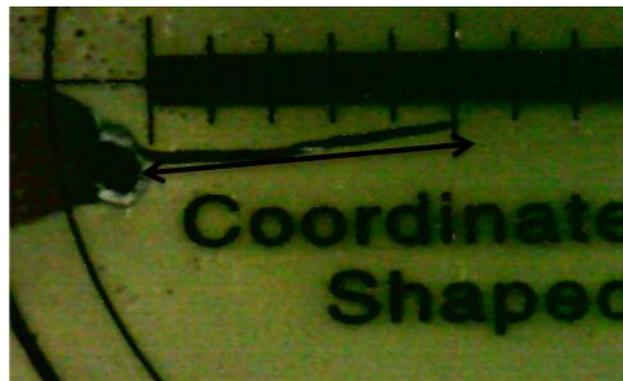
Gambar 4.3. Retak fatik pada saat *overload* dengan panjang retak 5,08 mm
