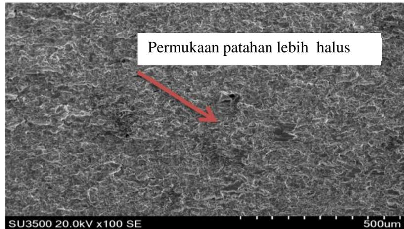
Gambar 4.7. SEM pada zona terbentuk nya retak dengan panjang 1,119 mm pada siklus 5000
