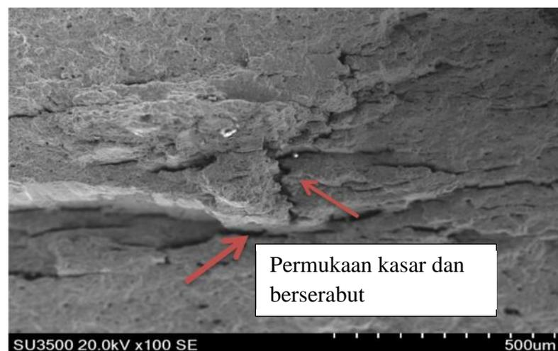
Gambar 18. SEM pada zona batas patah dengan panjang retak 1,620 mm pada siklus 17.160
