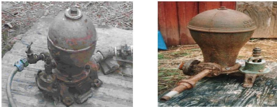
Gambar 2.1. *Hidraulic ram pump* pada awalnya (Calhoun, 2013)
