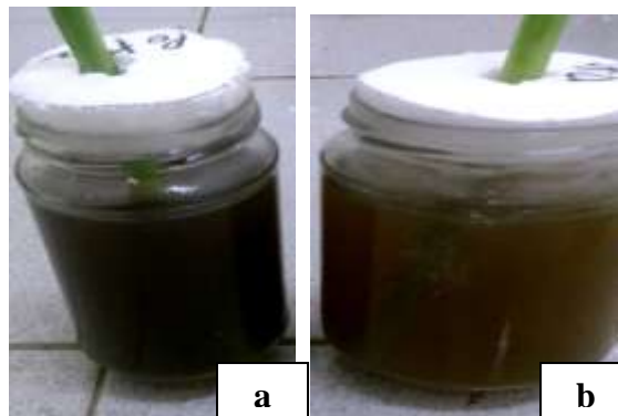
Gambar 4. Perubahan warna larutan yang mengandung \text{AgNO}_3 selama peragaan: a) larutan peraga tanpa penggantian; b) larutan peraga yang diganti setiap 3 hari.
