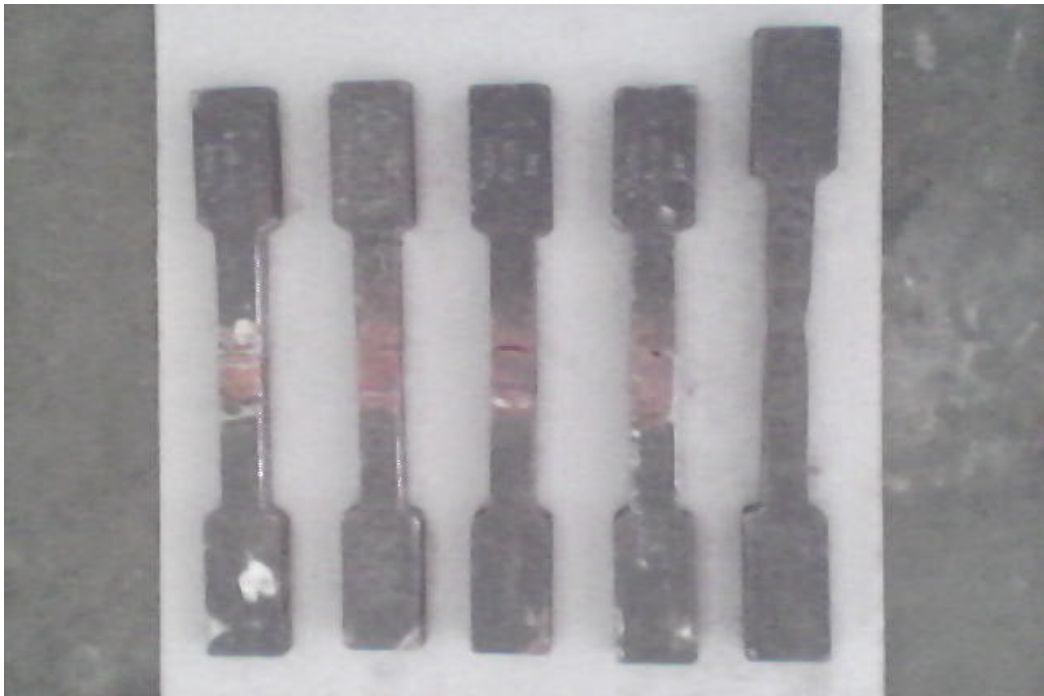
2. Gambar spesimen setelah uji tarik
