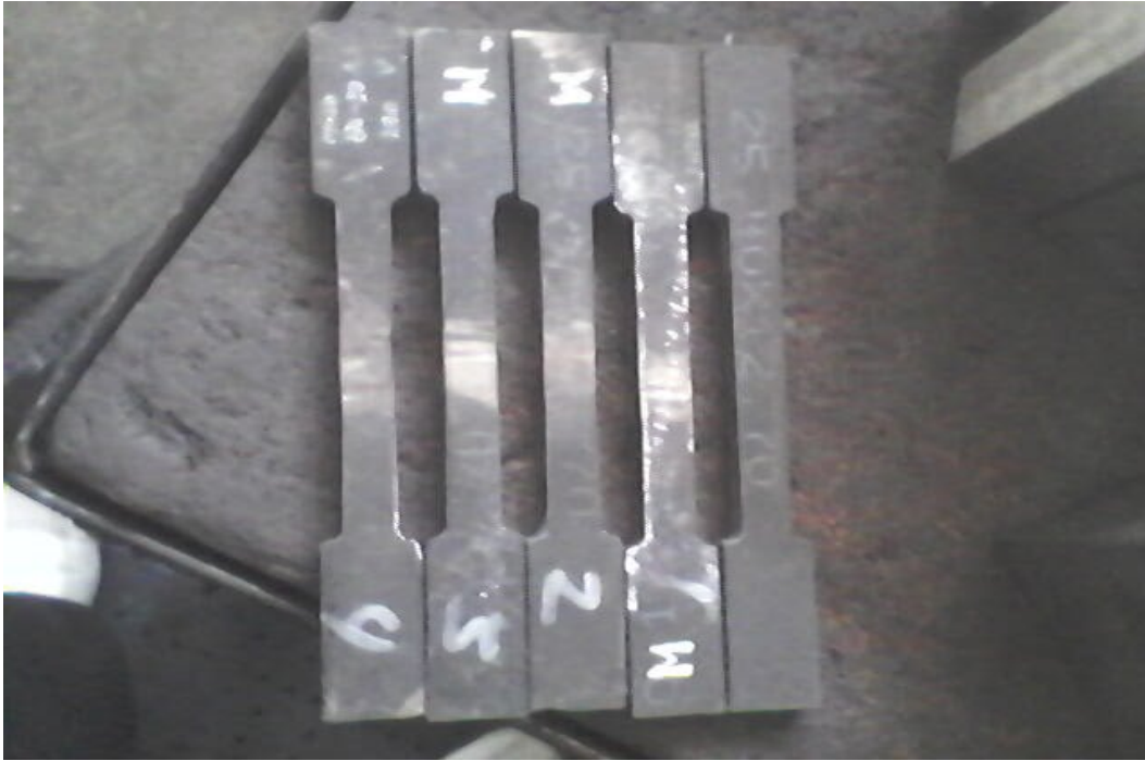
1. Gambar spesimen sebelum pengujian tarik
