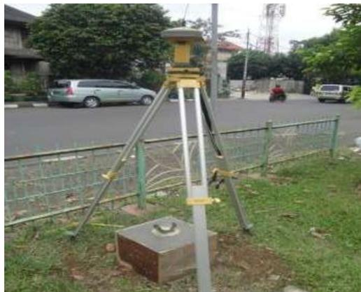
Gambar 2.4 GPS Geodetik
