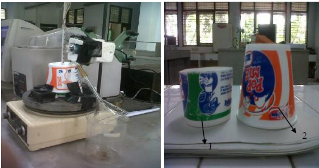
Gambar 2. Rangkaian Kalorimeter Sederhana yang Dipantau dengan Mikroskop Digital, (1) gelas kalorimeter; (2) penutup kalorimeter (Lestari, 2013)
