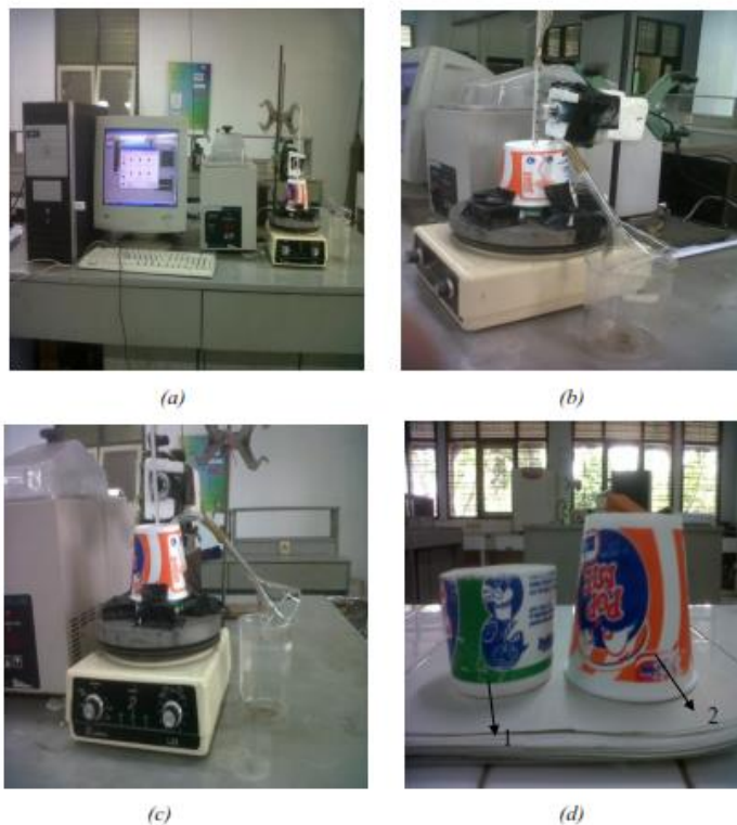
(a) Rangkaian kalorimeter dan mikroskop digital secara keseluruhan; (b) Rangkaian kalorimeter dan mikroskop digital dilihat dari samping; (c) Rangkaian kalorimeter dan mikroskop digital dilihat dari depan; (d) Gelas kalorimeter (1); penutup kalorimeter (2)
