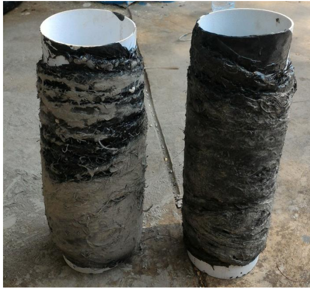
Gambar 3.8 Pipa PVC Berpenguat Ijuk dengan Matriks Paduan Aspal-Semen
