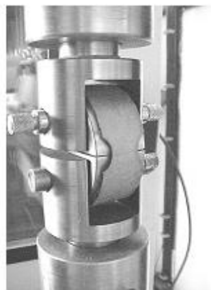
Gambar 3.16 Gambar Perlengkapan Alat Uji Split-Disk , yang Dirakit pada Mesin Uji Tarik (Erdiller, 2004)
