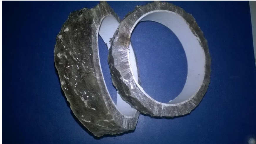
Gambar 3.12 Spesimen Uji Pipa PVC Bepenguat Ijuk Matriks Epoxy
