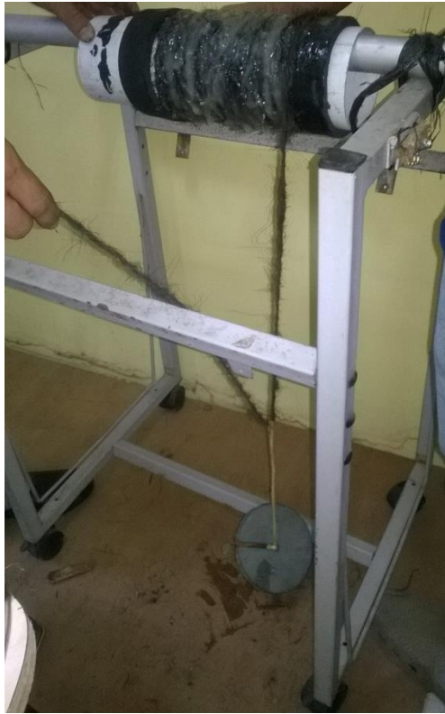
Gambar 3.10 Proses Pelilitan Pipa PVC Berpenguat Ijuk Matriks Epoxy
