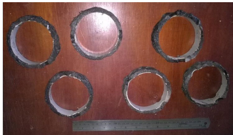
Gambar 3.9 Spesimen Uji Pipa PVC Berpenguat Ijuk Bermatriks Paduan Aspal-Semen
