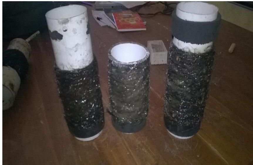
Gambar 3.11 Pipa PVC Berpenguat Ijuk Matriks Epoxy
