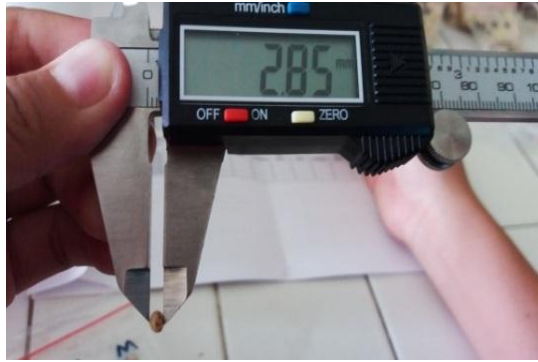
Gambar 7. Pengukuran tebal benih dengan alat jangka sorong
