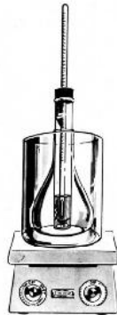
Gambar 5. Alat praktikum penurunan titik beku Marzzacco Collins ( Marzzacco dan Collins, 1980)
