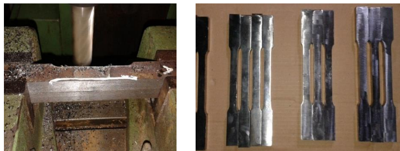
Gambar 3.4 Pembuatan Spesimen Uji tarik standar ASTM E-8
