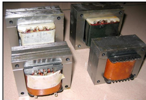
Gambar 2.22 Bentuk fisik Trafo [6]
