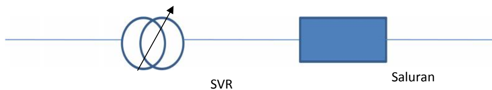
Gambar 2.4 Posisi SVR tipe B pada sistem distribusi
