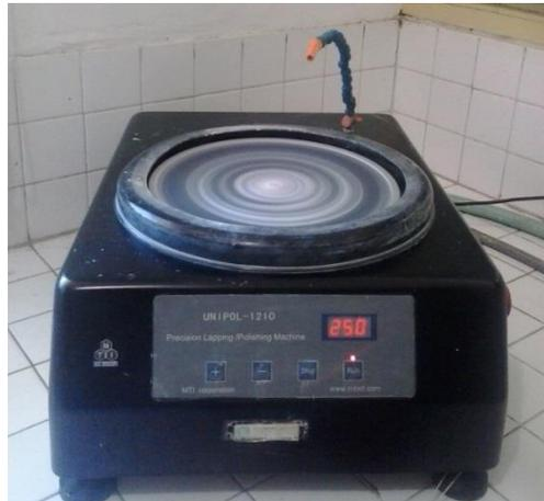
Gambar 25. Mesin amplas (*Grinder Polisher*)
