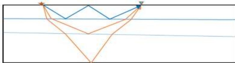
**Gambar 3.5** Perambatan gelombang refleksi primer (jingga) dan gelombang *multiple* (biru) dibawah permukaan bumi (Verschuur, 2006)
